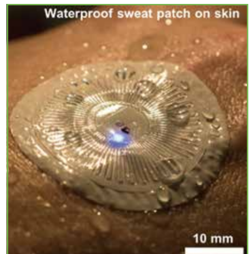
Abbildung: Farbumschlag-basierter Biosensor für die Schweißanalyse auf der Haut (Bildquelle: Reprinted from (19). © The Authors, some rights reserved; exclusive licensee American Association for the Advancement of Science. Distributed under a Creative Commons Attribution Non-Commercial License 4.0 (CC BY-NC) http://creativecommons.org/licenses/by-nc/4.0/ )
