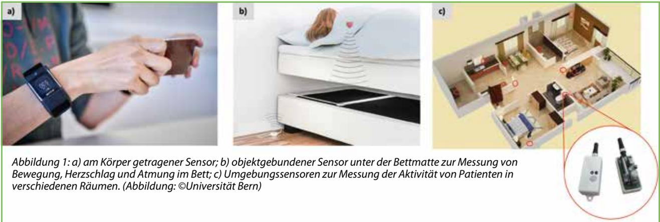
Abbildung 1: a) am Körper getragener Sensor; b) objektgebundener Sensor unter der Bettmatze zur Messung von Bewegung, Herzschlag und Atmung im Bett; c) Umgebungssensoren zur Messung der Aktivität von Patienten in verschiedenen Räumen. (Abbildung: ©Universität Bern)
