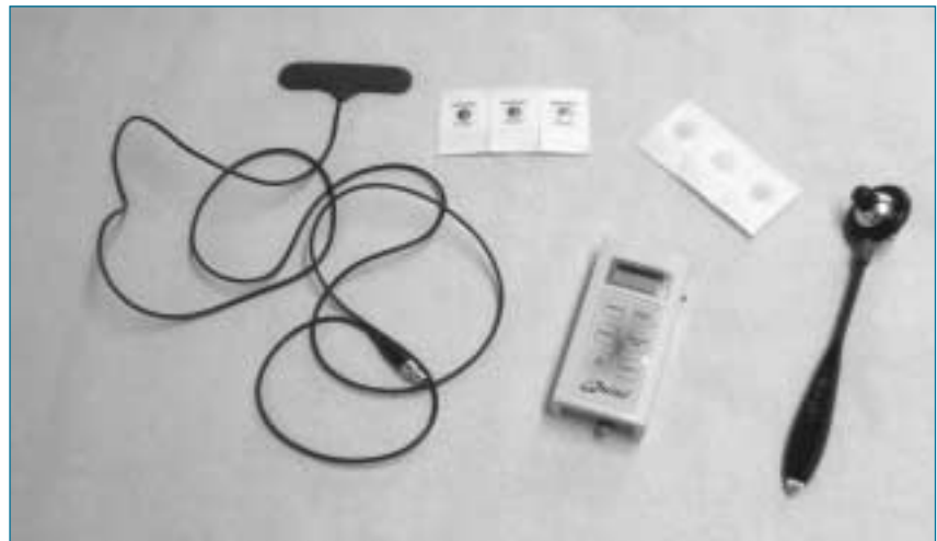
Quisi-Gerät: mittels Stirnelektrode abgeleitete, elektronisch auswertbare ambulante Schlafuntersuchung
