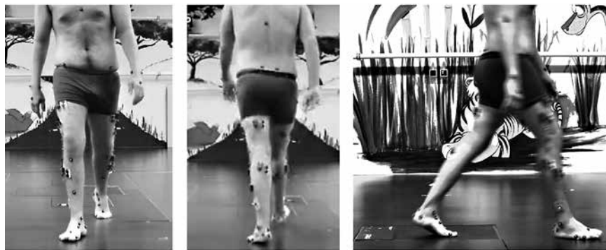
Abbildung 3: Videoaufnahmen im 3-D-Ganglabor mit aufgeklebten Markern (Kugeln) zur kinematischen Analyse und EMG-Elektroden zur Analyse der Muskelaktivität am Patienten sowie der Druckmessplatte am Boden
