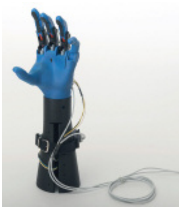
Universalhandprothese (links) und Handprothese zum Skifahren (rechts) aus dem 3D-Drucker (Fotos: ZHAW)
