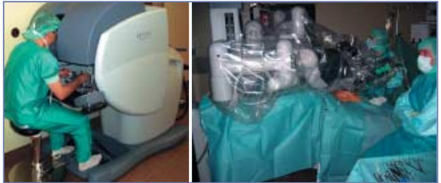
Abbildung 1: Die Da-Vinci-Technologie besteht aus einer Arbeitskonsole (links) und dem Roboterstativ (rechts). Das Stativ hält die Kamera und zwei bis drei Instrumentenarme. Der Chirurg führt die Instrumente von der Konsole mit dreidimensionaler Sicht und voller Bewegungsfreiheit.
