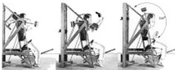
Abbildung 1: Mit der Pull-over Maschine war es erstmals möglich, den Latissimus dorsi von der maximalen Dehnung bis in die vollständige Kontraktion mit einer einzigen Übung zu trainieren.
