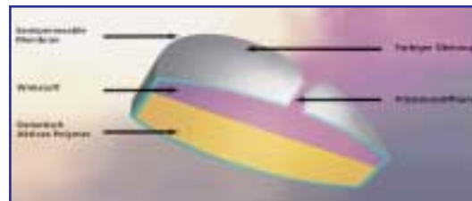
Abbildung 1: Die OROS®-Technologie funktioniert nach dem «Push-Pull»-Prinzip: Der Wirkstoff Oxybutynin wird, zusammen mit einem osmotisch aktiven Druckkompartiment, von einer semipermeablen Membranhülle umgeben. In einer wässrigen Lösung dehnt sich der osmotische Kern aus und drückt den Wirkstoff kontinuierlich während 24 Stunden durch eine Präzisionsöffnung.
