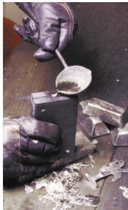
Das 400 Grad heisse Zinn wird mit dem Gusslöffel in die doppelseitige Form gefüllt, während die Luft durch feine Kanäle im Modell entweicht.
