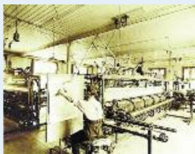
Handstickmaschine um 1910; der Sticker führt den Pantographen.
