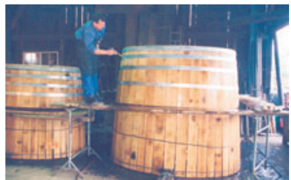
Biegen der Dauben mit Wasser und Feuer
