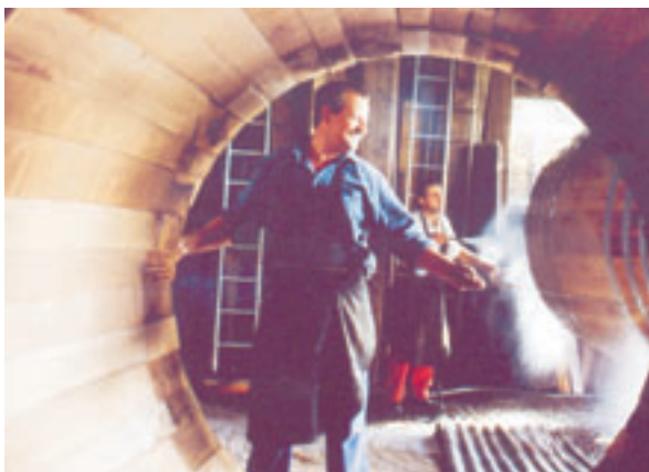
Absbrechen des Fasses nach dem Feuern
