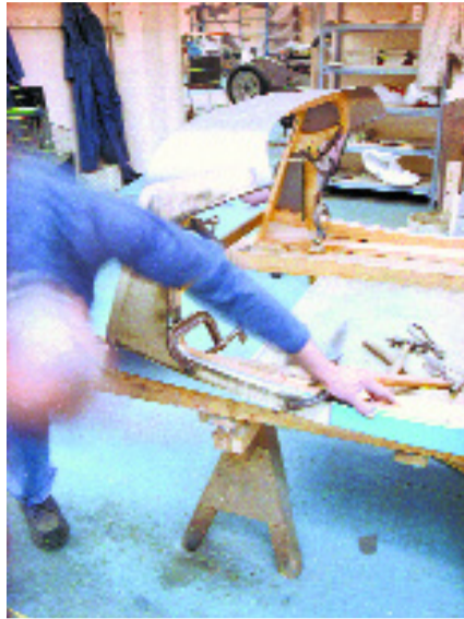
Massanzug: Das Eschenholzgerippe wird mit Aluminium gekleidet.
