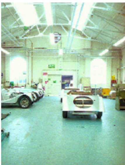
Vor der Lackierung: Die mit Aluminium beplankte Robkarosserie
