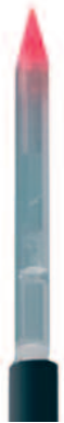
Abbildung 2: Die Lasersonde hat eine scharfe Spitze und gibt dort ihre Energie ab.
