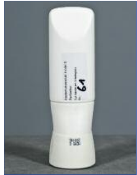
Abbildungen 2a und 2b: Elektronische Registriertube für die Hautschutz-Anwendung. Links: MEMS-TrackCap, Adapter und Tubenflasche mit Beschriftung. Rechts: Fertig montierte Einheit, Adapter mit Tubenflasche verklebt.
