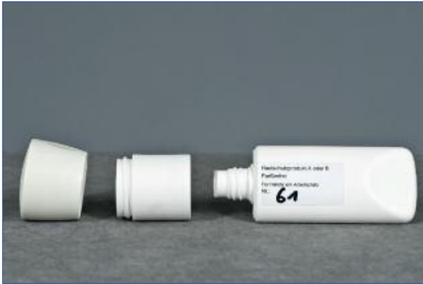
Abbildungen 2a und 2b: Elektronische Registriertube für die Hautschutz-Anwendung. Links: MEMS-TrackCap, Adapter und Tubenflasche mit Beschriftung. Rechts: Fertig montierte Einheit, Adapter mit Tubenflasche verklebt.
