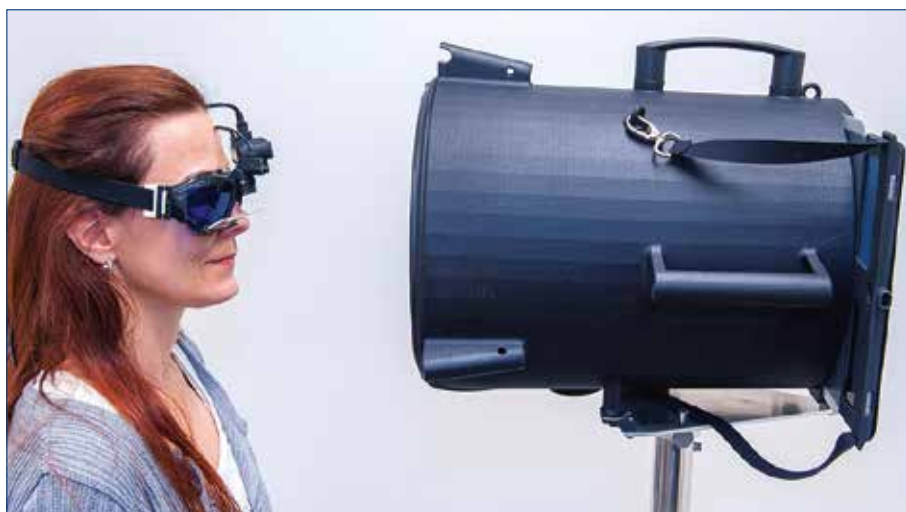
Die Apparatur zur Bestimmung des Nystagmus beim Wechsel vom Dunkeln ins Licht besteht aus einer Videobrille, einer kleinen Dunkelkammer und einem Tablet (Bild: G. Pauciello, Inselspital).
