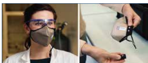
Die Maske besteht aus einem mehrlagigen Textil, Elektroden und einer kleinen Batterie (Fotos: ZHAW/Hannes Heinzer).
