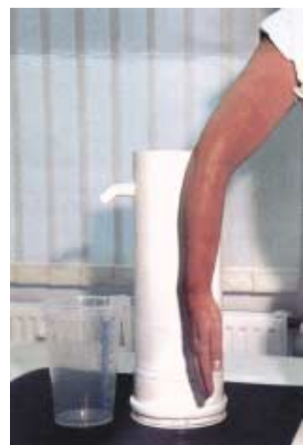
Abbildung 3: Haltung von Fingern und Handgelenk beim Eintauchen in das Volumeter.
