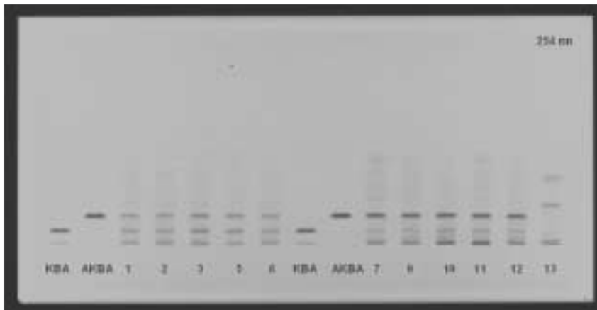
Abbildung 7: HPTLC von B. serrata (Nr. 1–6), B. sacra (Nr. 7–12) und B. frereana (Nr. 13), Referenz: KBA und AKBA
