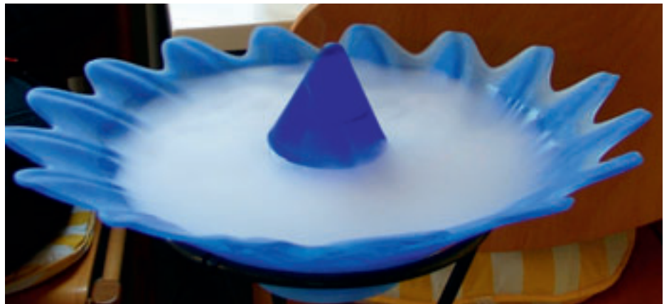
Abbildung 1: Zimmerspringbrunnen auf Ultraschallverneblerbasis. In die offene Glasschale wird Wasser gefüllt, in deren Mitte befindet sich die Verneblereinheit auf Ultraschallbasis.
